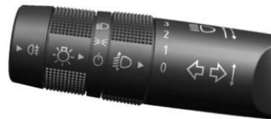
Mueva la palanca completamente hacia arriba o hacia abajo para señalar una vuelta.
