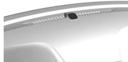
Hay un sensor de luz en la parte superior del tablero de instrumentos. No cubra el sensor.
