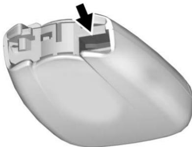
2. Separe las dos mitades del transmisor utilizando una herramienta plana insertada en el área cerca a la ranura de la llave.
