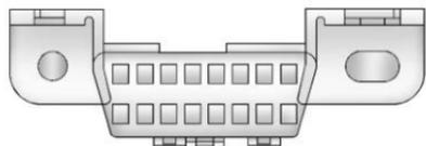
El DLC está debajo del tablero de instrumentos del lado izquierdo del volante. Conectar dispositivos que no se utilicen para realizar una Inspección de emisiones/Prueba de mantenimiento o para dar servicio al vehículo puede afectar la operación del vehículo. Vea *Equipo eléctrico incorporado* ⇨ 166. Visite a su distribuidor si necesita asistencia.
