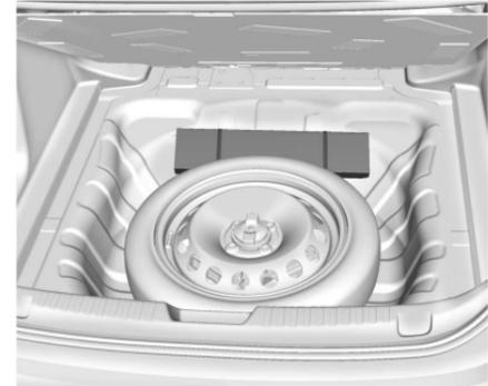
El triángulo de emergencia está almacenado debajo del piso de la cajuela junto a la llanta de refacción.
