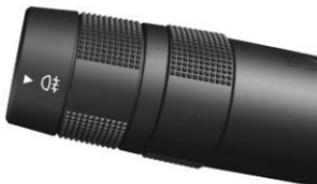
☁: Gire la banda en la palanca a ☁ para encender las luces antiniebla traseras.
