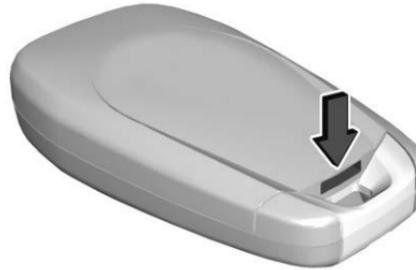
1. Inserte un objeto plano y delgado en el hueco y separe y retire la cubierta posterior del transmisor.
