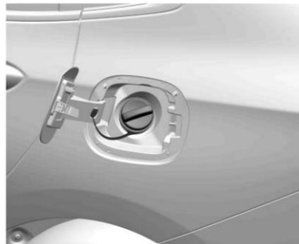
Para retirar el tapón de combustible, hágalo girar en sentido inverso al de las manecillas del reloj. Cuando cargue combustible, cuelgue el tapón de combustible en gancho de la puerta de combustible. Inserte completamente y asegure la boquilla de relleno, y después comience el reabastecimiento.
