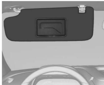
Tire de la visera hacia abajo para bloquear el resplandor. Desprenda la visera del montaje central para girarla a la ventana lateral.
