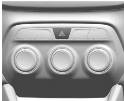
$\triangle$  : Presione  $\triangle$  para hacer que las luces direccionales delanteras y traseras destellen intermitentemente. Presione nuevamente para apagar las intermitentes.
