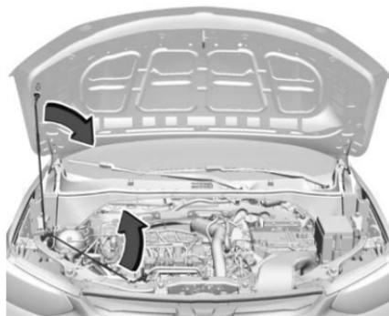
3. Levante el cofre y libere la varilla del soporte del cofre de su retenedor en el frente del compartimiento del motor. Inserte firmemente el extremo de la varilla dentro de la ranura, en la parte inferior del cofre.
