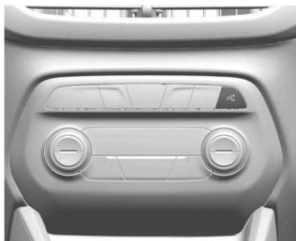
Presione **P** con el símbolo de advertencia para permitir al sistema buscar un lugar de estacionamiento suficientemente grande y a una distancia de 1.5 m (5 pies) del vehículo. La velocidad del vehículo debe ser menor a 30 km/h (18 mph).
