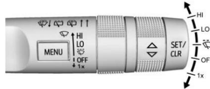
La palanca del limpiaparabrisas/lavador está en el lado derecho de la columna de dirección. Con la ignición encendida o en ACC/ACCESSORY (accesorios), mueva la palanca del limpiaparabrisas para seleccionar la velocidad del limpiador.
